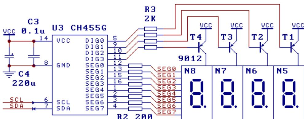
在为 DIG0~DIG3 字引脚增加反相器后，CH455 可以驱动共阳数码管。图中是由 4 只 PNP 三极管
