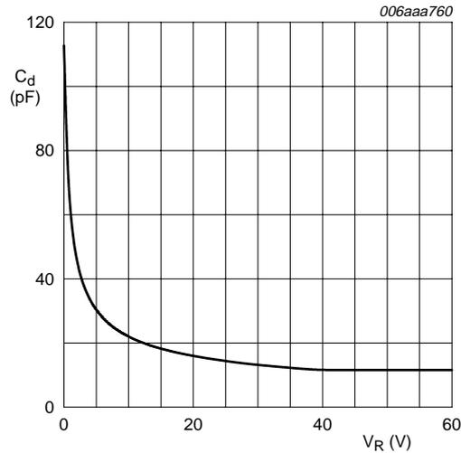
$f = 1\text{ MHz}; T_{amb} = 25\text{ °C}$
